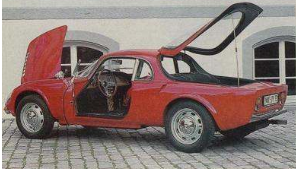
Besten Zugang zum Motor- und Gepäckraum bot die große Heckklappe.
